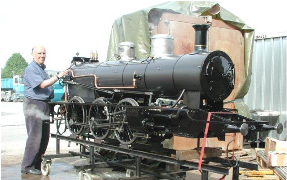
A 3/5 – Revision: erstes Probeheizen
